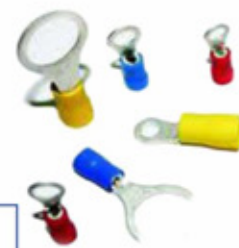
TERMINALES PRE-AISLADAS RV2-6 (1,5-2,5MM) AZUL RV 3.5-4 (2,5-4MM) NEGRO RV5.5-6 (4-6MM) AMARILLO
