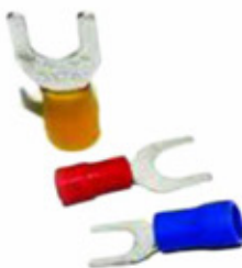
TERMINALES PRE-AISLADAS SV2-8 (1,5-2,5MM) AZUL SV3.5-5 (2,5-4MM) NEGRO SV5.5-5 (4-6MM) AMARILLO
